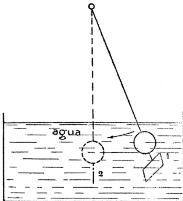
Fig. 5.<sup>a</sup>—*Movimiento del péndulo en el agua.*—El péndulo, desviado de su posición de equilibrio y abandonado en el agua, recobra su posición vertical sin efectuar oscilaciones, en virtud de la resistencia del líquido, que amortigua el movimiento.
