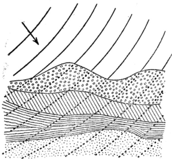
Fig. 21.—Terreno aislador permeable para las ondas. No se modifica el campo superficial de la radiación. No hay ondas reflejadas ni difundidas.
