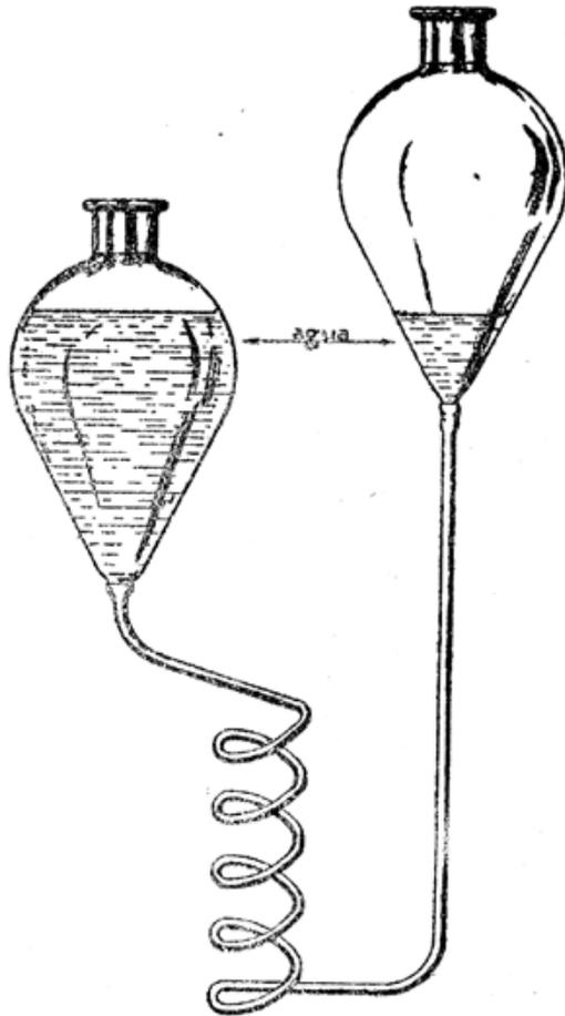
Fig. 7.<sup>a</sup>—Oscilaciones del agua entre dos recipientes que se comunican por un largo tubo de pequeño diámetro. — En este caso las oscilaciones son más lentas porque el tubo ofrece una gran resistencia al desplazamiento del agua y porque el agua emplea mucho más tiempo para pasar de un recipiente al otro. Si la resistencia del tubo es suficientemente grande, el agua cesa de moverse cuando ha alcanzado el nivel de equilibrio y no efectúa ninguna oscilación.
