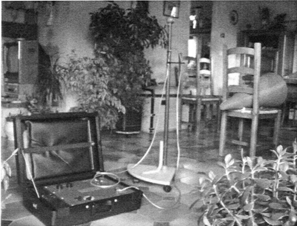
Photo n°12 – Création d'un court-circuit entre les deux fils de sortie du générateur
